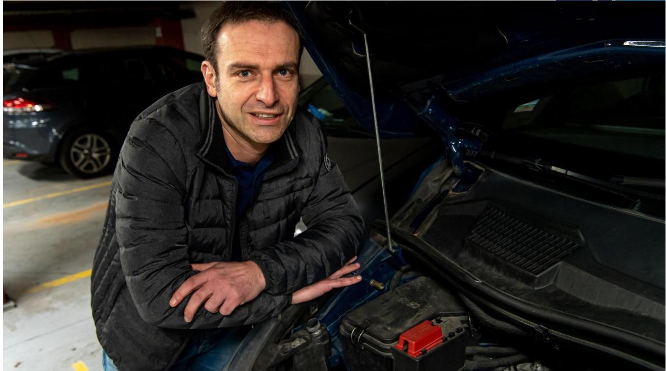
À l'usage, des cristaux se forment avec le vieillissement de la batterie et finissent par attaquer le métal. Les rendements baissent, on pense à la changer. Une filière existe pour récupérer les batteries collectées, souvent broyées pour tenter de valoriser la quinzaine de kilos de métaux, et notamment le plomb, cette cochonnerie de métal lourd pour la nature et la santé.
